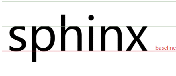
图 5-2 CSS 中的基线示意
