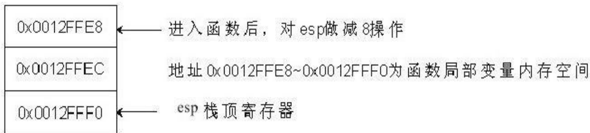
图 6-3 使用esp寻址栈空间
