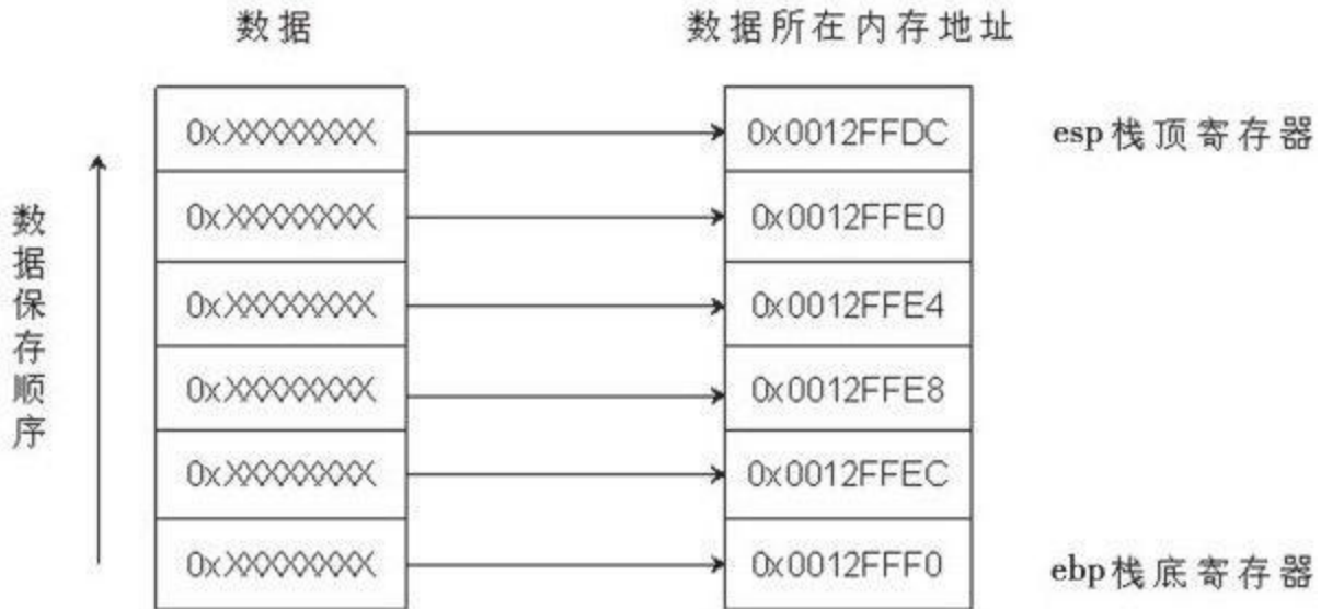
图 6-1 栈的结构示意图
