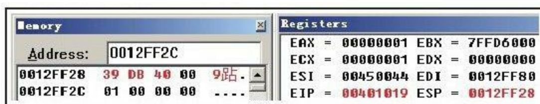
图 6-5 执行call指令后esp与栈中内存数据的信息
