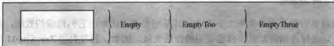
图 16.2 实现 EBCO 的编译器对 EmptyThree 的布局
